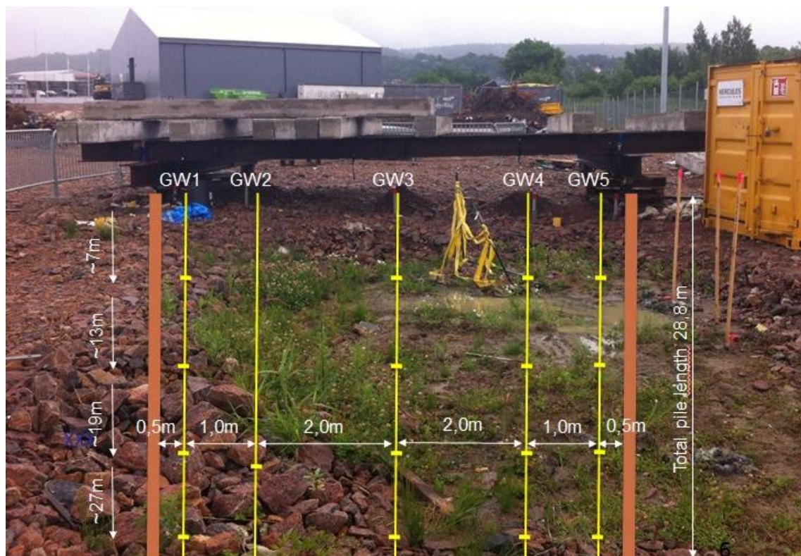
Figur 3. Mätsensorernas placering i jordprofilen mellan de två försökspälarna av stål (bruna i figuren). Sensorerna för temperatur och portryck är markerade med horisontella tvärstreck, sammanlagt 17 st. De vertikala gula linjerna motsvarar placeringen av bägslangarna för sättningsmätning.
